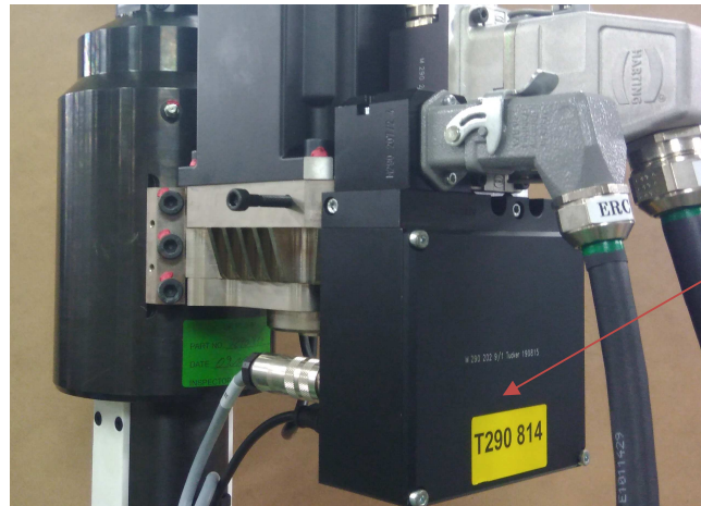
図4. DDC ボックス
