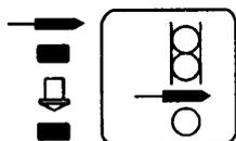
**機能：**この“エスケープ”タッチ・スイッチにて、エスケープメント・ブロック部のエスケープメント・スライドを閉じたり開いたりします。このスイッチは、“Manual（手動）”モードで動作します。
