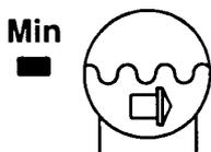
**機能：**この“スタッド・レベル”LEDは、回転ドラム内のスタッドの量が十分入っていることを示します。このLEDは、“Auto（自動）”と“Manual（手動）”モードで動作します。
