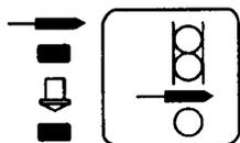
**機能：**この“スタッド分離シャッター”タッチ・スイッチにて、エスケープメント・ブロック部のスタッド分離シャッターを閉じたり開いたりします。このスイッチは、“Manual（手動）”モードで動作します。
